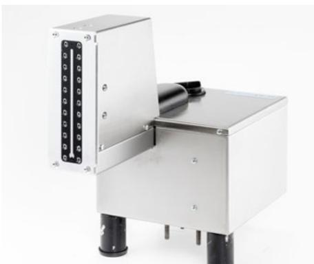
Cette tête d'impression jet d'encre industrielle Trident utilise la technologie piézoélectrique pour une impression de qualité. Elle permet de marquer sur le dessus ou le côté des cartons avec une hauteur de 50 ou 100mm et une résolution de 64 dpi pour les caractères ou logos et 192 dpi pour les code-barres. Cette tête d'impression se combine à un système de marquage ou un contrôleur regroupant 2 à 8 têtes d'impression.
