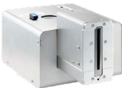
Cette tête d'impression jet d'encre Xaar offre une impression haute résolution pour le marquage des cartons avec une hauteur de 72mm et une résolution de 180 dpi pour les caractères, logos et code-barres. Cette tête d'impression se combine à un système de marquage ou un contrôleur regroupant 2 à 8 têtes d'impression.
